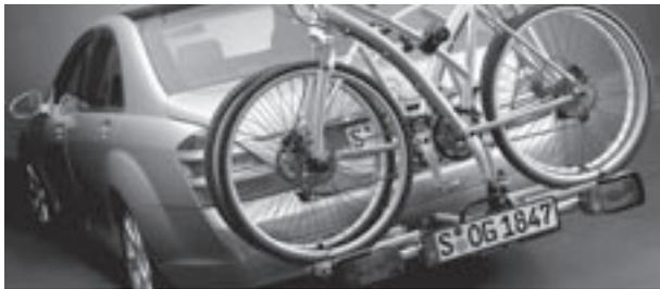
Heckfahrradträger für Anhängervorrichtung
