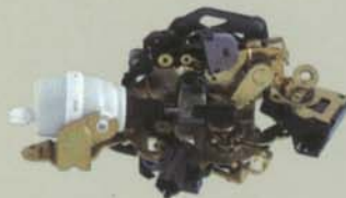
Türenschießen ohne Kraftaufwand: mit der Servoschließung.
