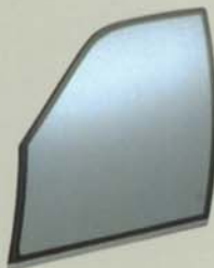
Das erste Mal in einem Pkw: die doppelte Seitenverglasung.
