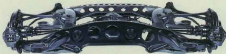
Die Doppelquerlenker-Vorderachse sorgt für ein besseres Fahrverhalten.
