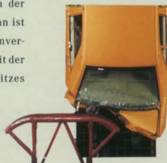
Die neue S-Klasse ist neben dem versetzten Frontalaufprall auch auf einen versetzten Heckaufprall ausgelegt.
