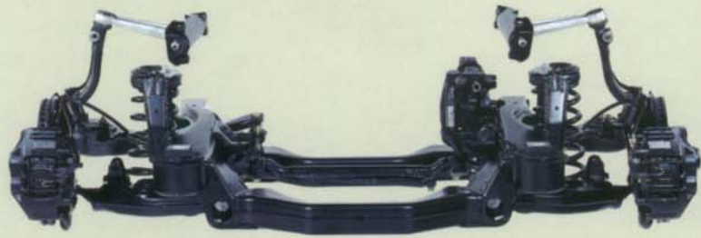
Die Doppelquerlenker-Vorderachse sorgt für ein besseres Fahrverhalten.
