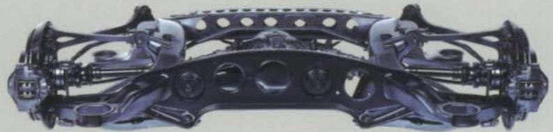
Die Doppelquerlenker-Vorderachse sorgt für ein besseres Fahrverhalten.
