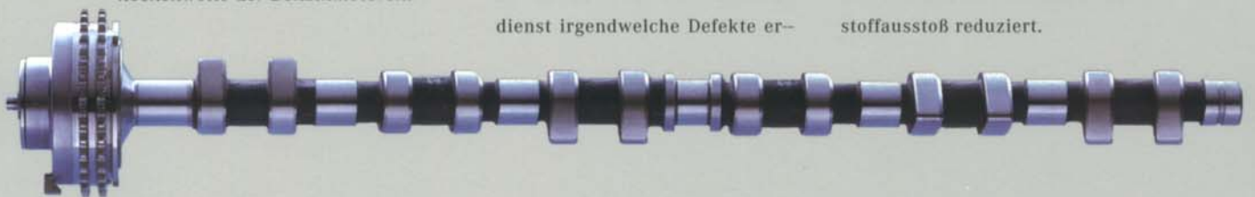
Die kennfeldgesteuerte Einlaßnockenwelle der Benzinmotoren.
