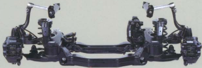
Die Doppelquerlenker-Vorderachse sorgt für ein besseres Fahrverhalten.
