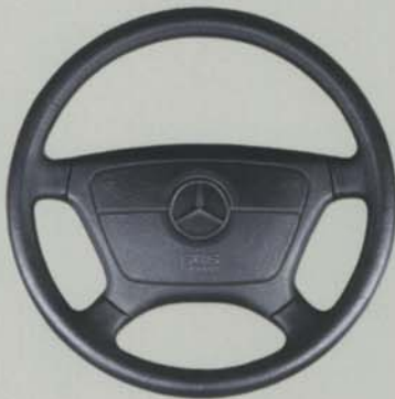
Im Normalfall werden Sie den Airbag nicht bemerken, aber wenn Sie ihn brauchen, bläst er sich in 30 Millisekunden auf.
