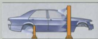
Steinschlag-Zwischengrundierung und Füller
