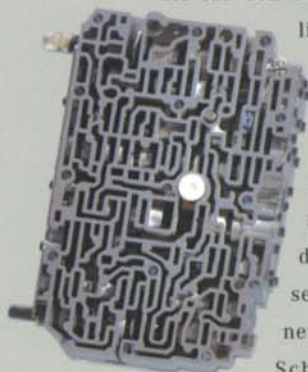
Das Schaltschiebergehäuse ist das „Gehirn“ eines Automatikgetriebes.
