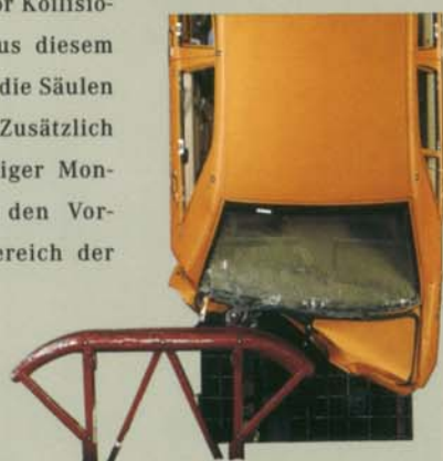
Die neue S-Klasse ist neben dem versetzten Frontalaufprall auch auf einen versetzten Heckaufprall ausgelegt.
