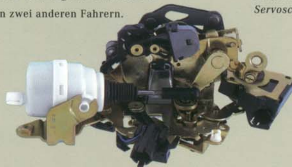
Türenschießen ohne Kraftaufwand: mit der Servoschließung.
