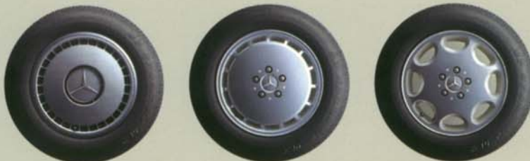
Die verschiedenen Felgen der S-Klasse. Lieferbar als Stahlscheibenrad, Leichtmetallgußrad (600 SE/SEL) und Leichtmetallschmiederad (auf Wunsch).
