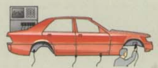
Elektronisch gesteuerte Hohlraum-Konservierung
