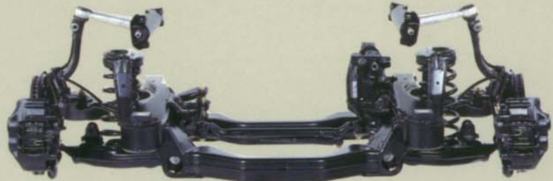
Die Doppelquerlenker-Vorderachse sorgt für ein besseres Fahrverhalten.
