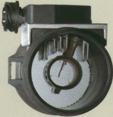
Der Hitzdraht-Luftmassenmesser, das präziseste Meßgerät zur Gemischauflbereitung.
