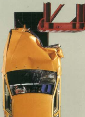
Die neue S-Klasse ist neben dem versetzten Frontalaufprall auch auf einen versetzten Heckaufprall ausgelegt.
