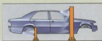
Steinschlag-Zwischengrundierung und Füller
