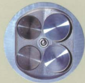
Im Vergleich zur 2-Ventil-Technik bietet die 4-Ventil-Technik eine deutlich größere Ventilfläche.
